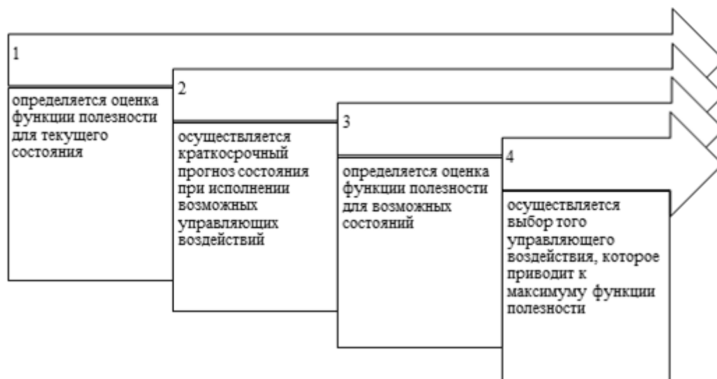
Рис. 2. Алгоритм интеллектуального управления БПЛА
