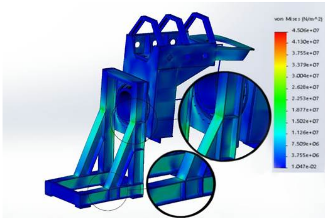
Рисунок 7. Графическое представление напряжений на опорную станину гантри на основе швеллера
