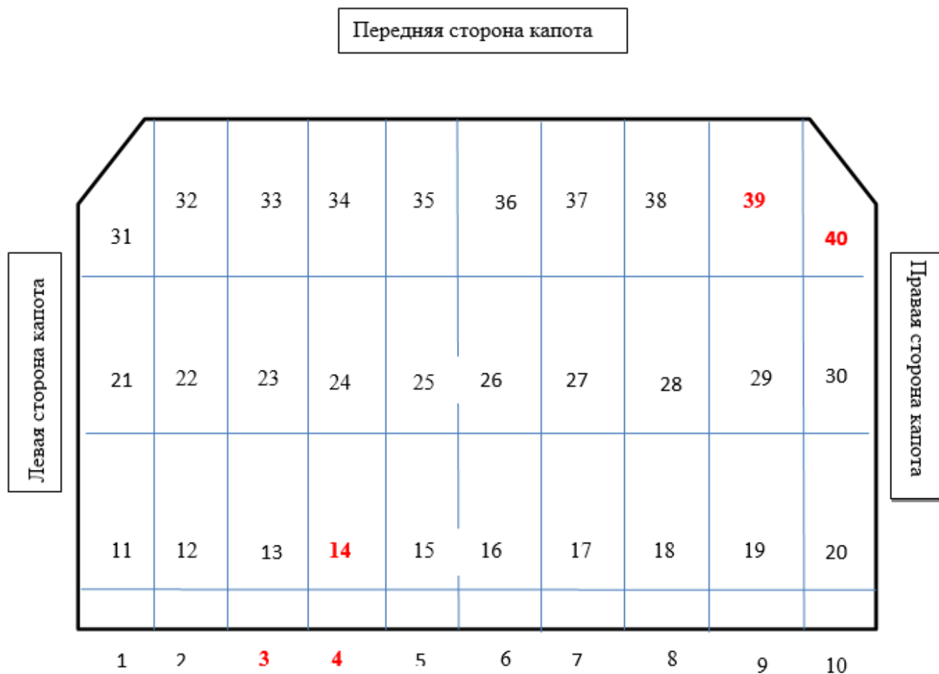
Рисунок 1. Схема размещения зон измерения тока размагничивания на верхней стороне капота.
