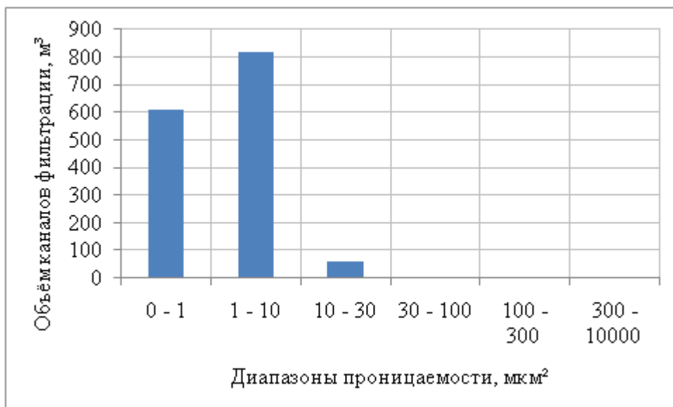
Рисунок 4 - Распределение объёмов каналов фильтрации по диапазонам проницаемости
