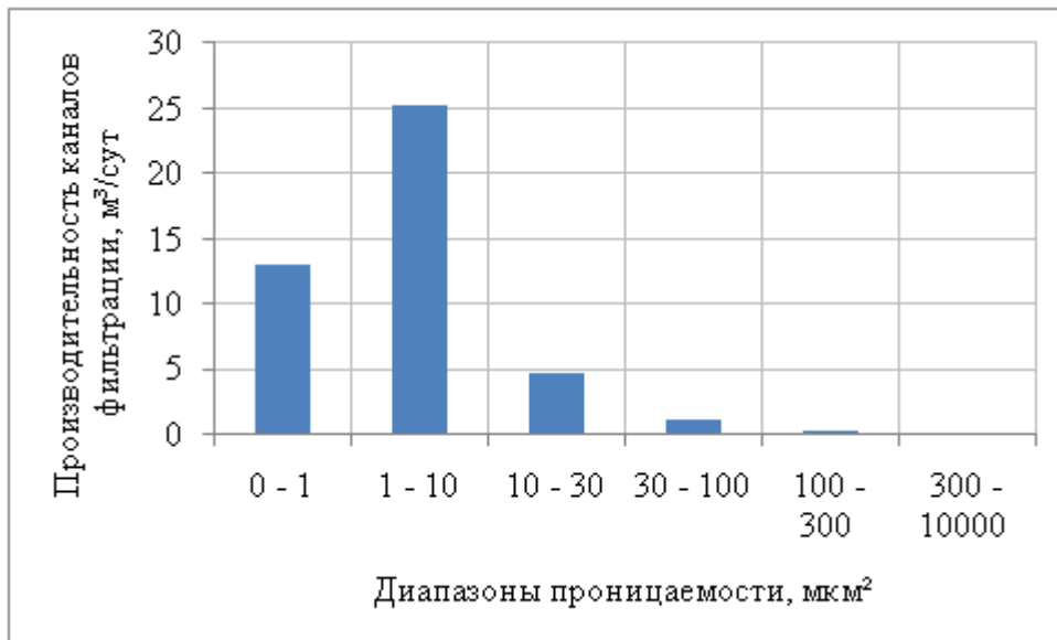
Рисунок 3 - Распределение производительностей каналов фильтрации по диапазонам проницаемости участка
