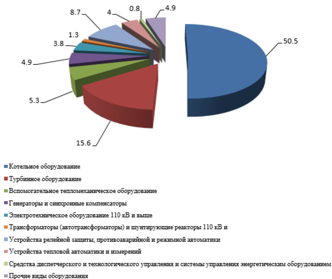
Рис.1. Причины аварий на ТЭЦ
