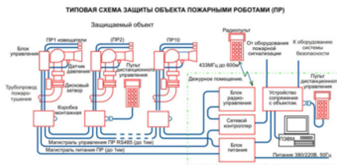
Рис.2. Типовая схема защиты объекта теплоэнергетики пожарными роботами
