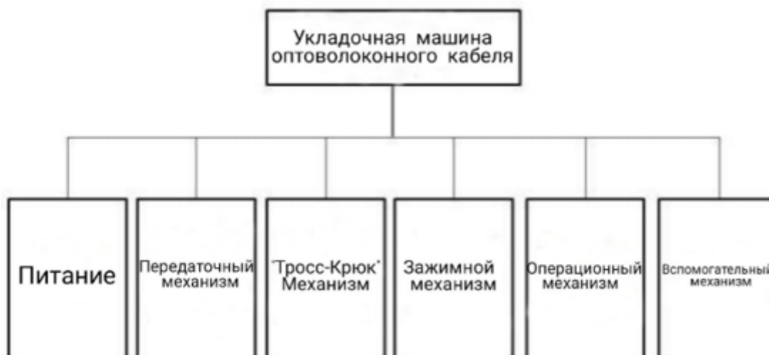
Рисунок 1 - Функциональная структура транспортного средства для прокладки волоконно-оптических кабелей.
