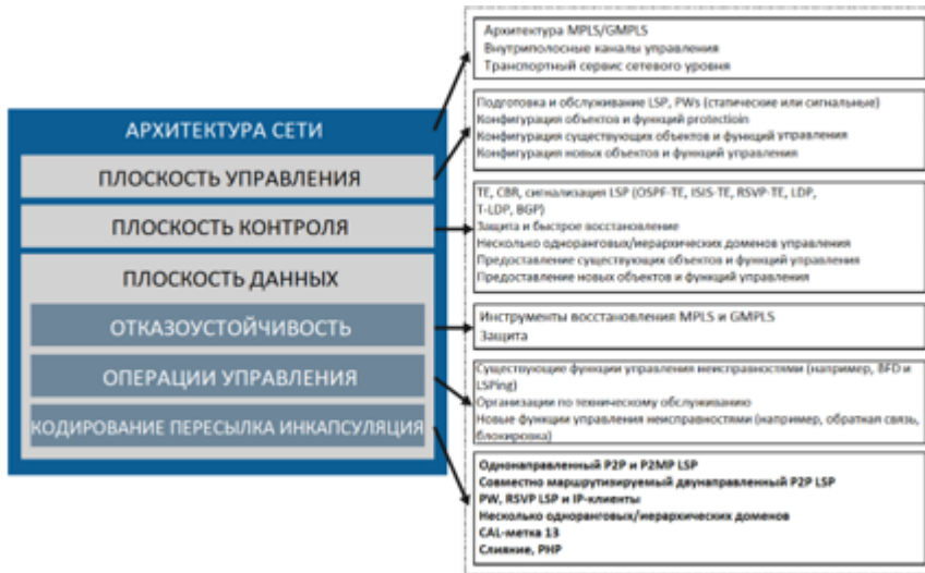
Рисунок 1: Компоненты MPLS и MPLS-TP.
