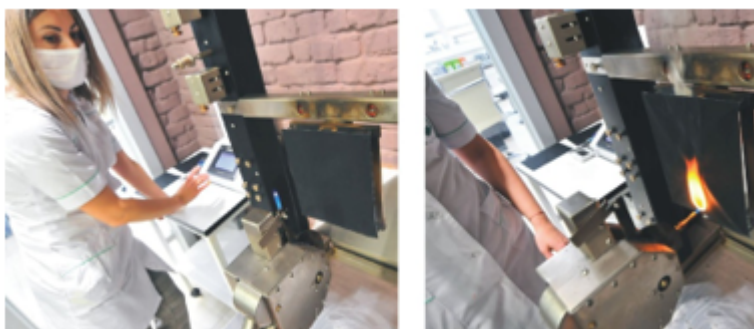
Рисунок 1 - Проведение огневого теста по ГОСТ ISO 15025
