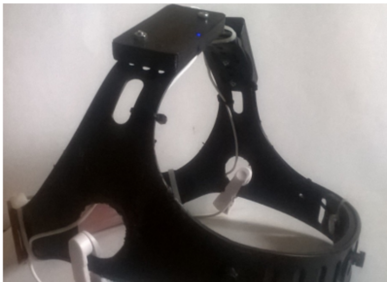
Рисунок 2 -ИМК в сборе и включен, о чем сигнализирует синий светодиод-индикатор на модуле блютуз BT04-A
