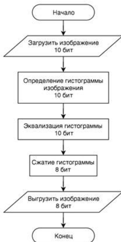
Рисунок 5. Адаптированный алгоритм сжатия изображения для преобразования выходных данных в данные для отображения (разрядность 8 бит)
