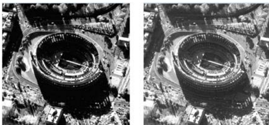
Рисунок 2. Разрешающая способность 8 бит/пиксел (слева) и разрешающая способность - 11 бит/пиксел (справа)
