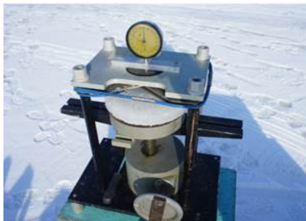
Рисунок 1 - Полевая испытательная машина ПИМ-200М.
