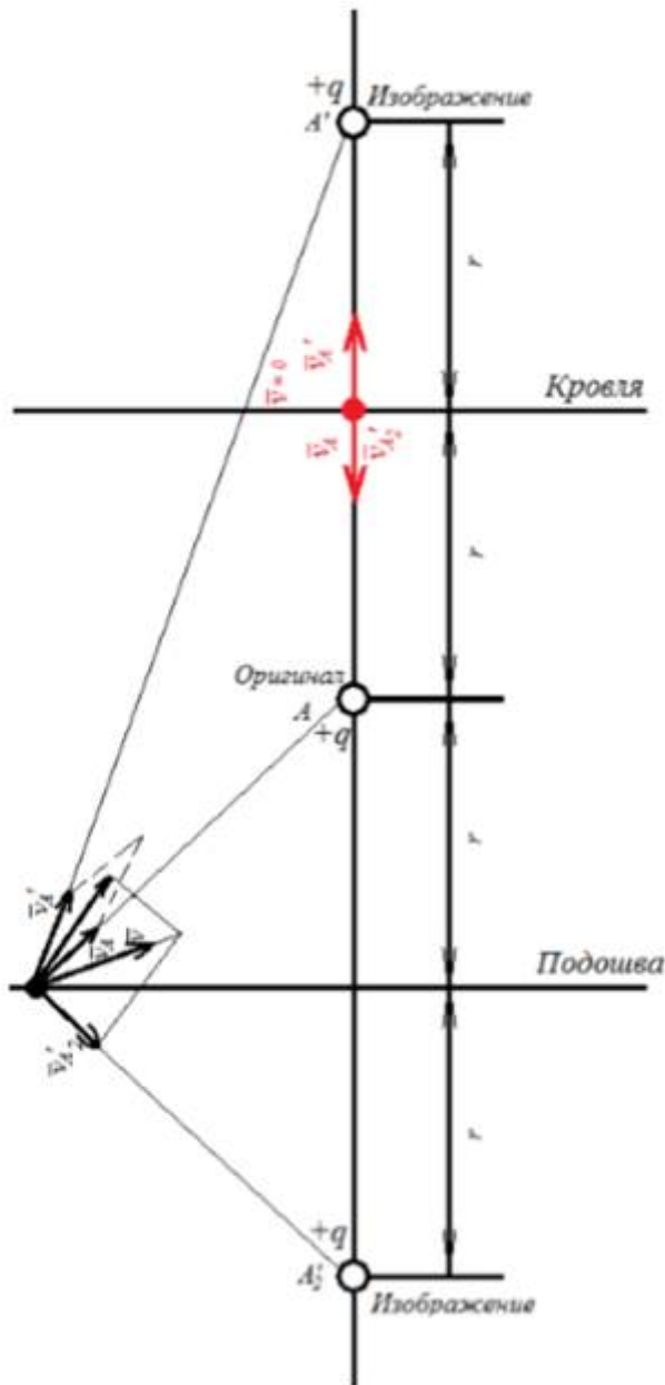
Рис. 2 — Вектор скорости течения флюида с работающими исходной скважиной и двумя отраженными скважинами
