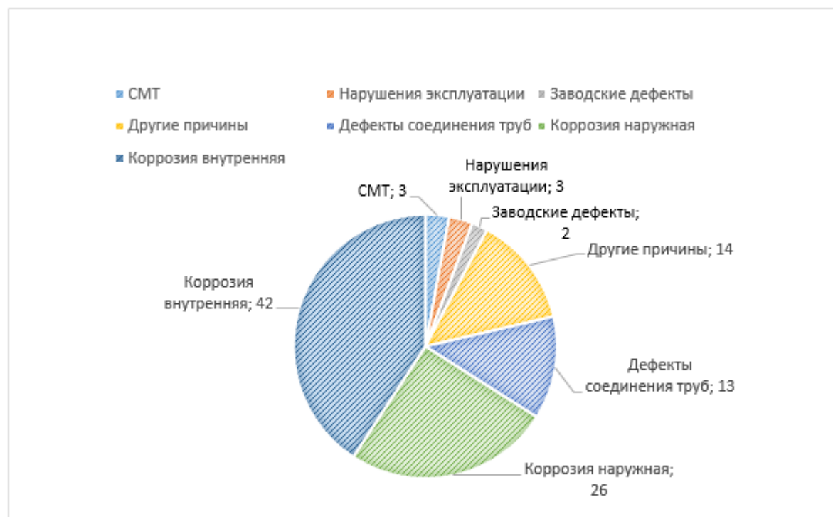
Рис. 1. Анализ причин отказов промышленных трубопроводов
