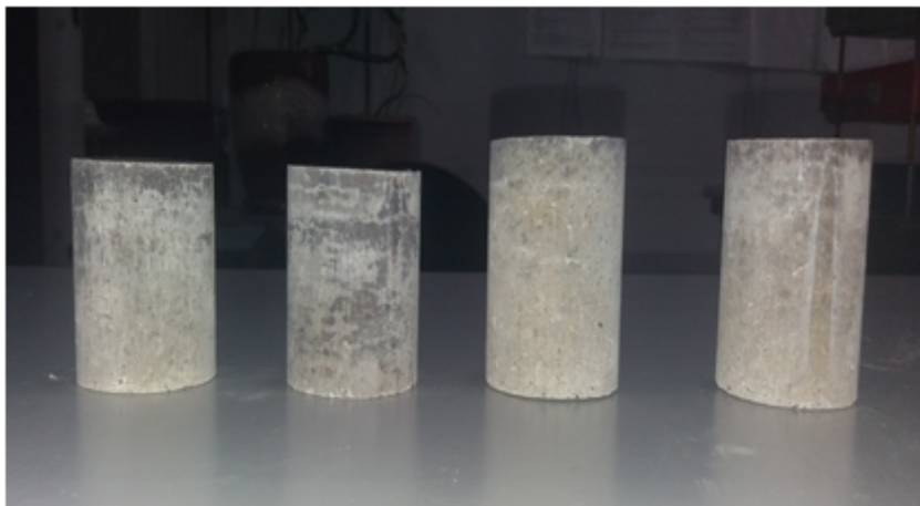
Рис. Золобетонные образцы-цилиндры после 28 суток твердения.
