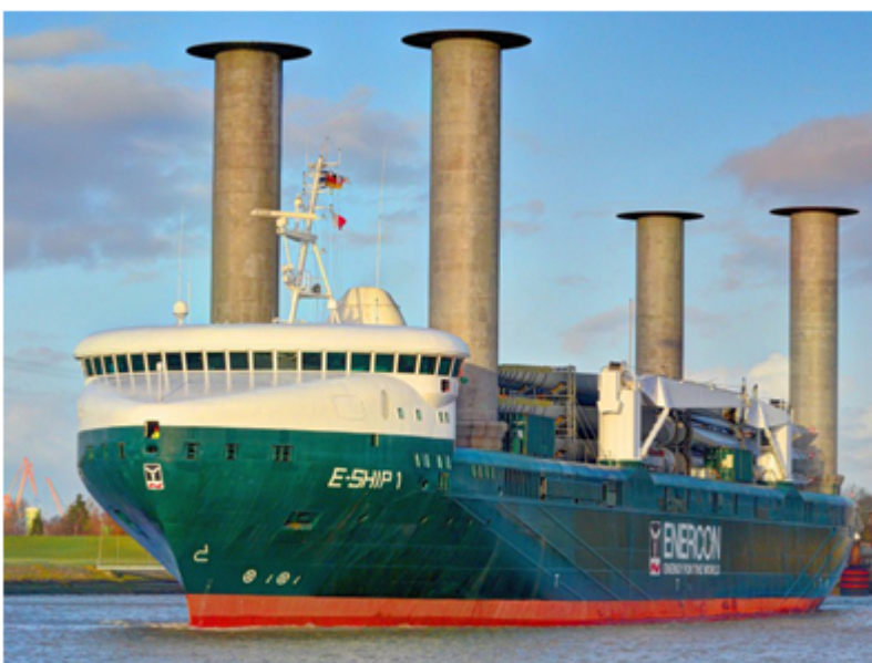
Рис. 2. Судно «E-Ship», использующее энергия турбопаруса
