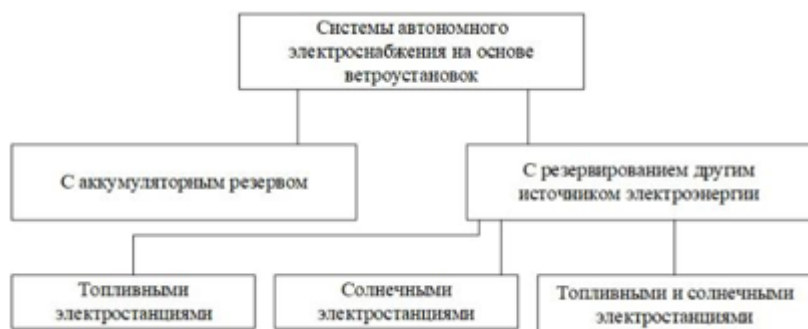
Рисунок 6 – Основные системы автономного электроснабжения на основе ветроэнергетических установок
