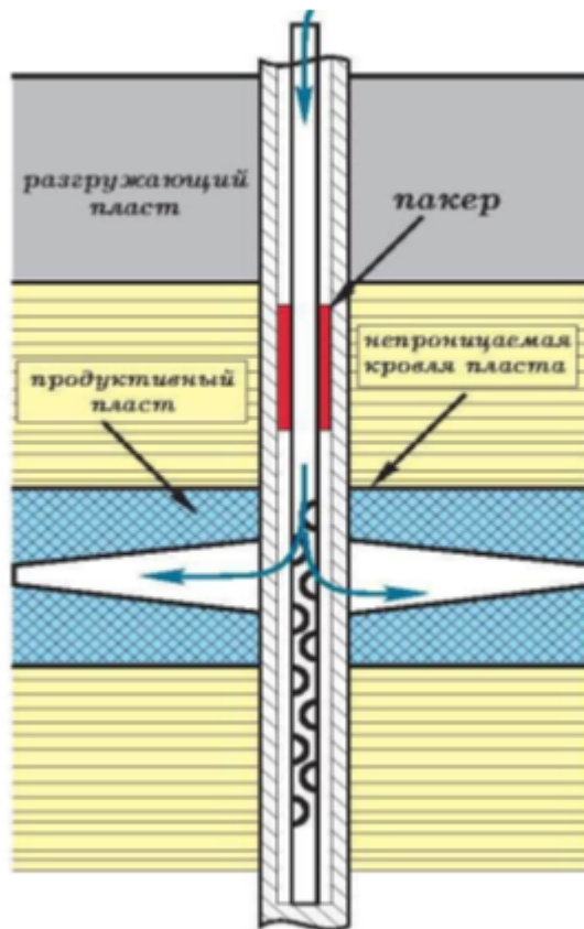
Рисунок 3 - Схема образования вертикальной трещины
