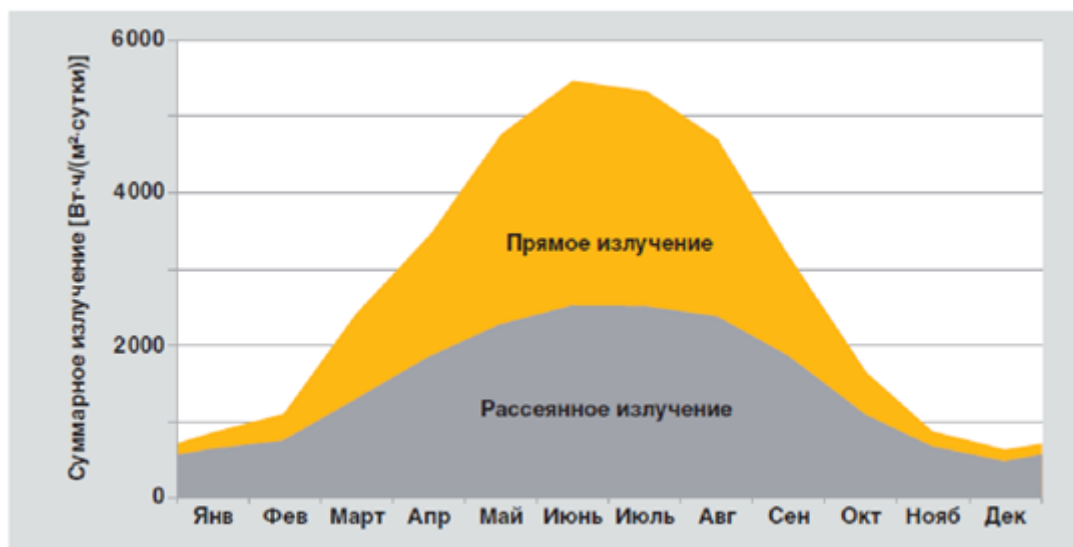
Рисунок 1 - Среднее значение среднесуточного суммарного излучения в течение года для территории Краснодарского края
