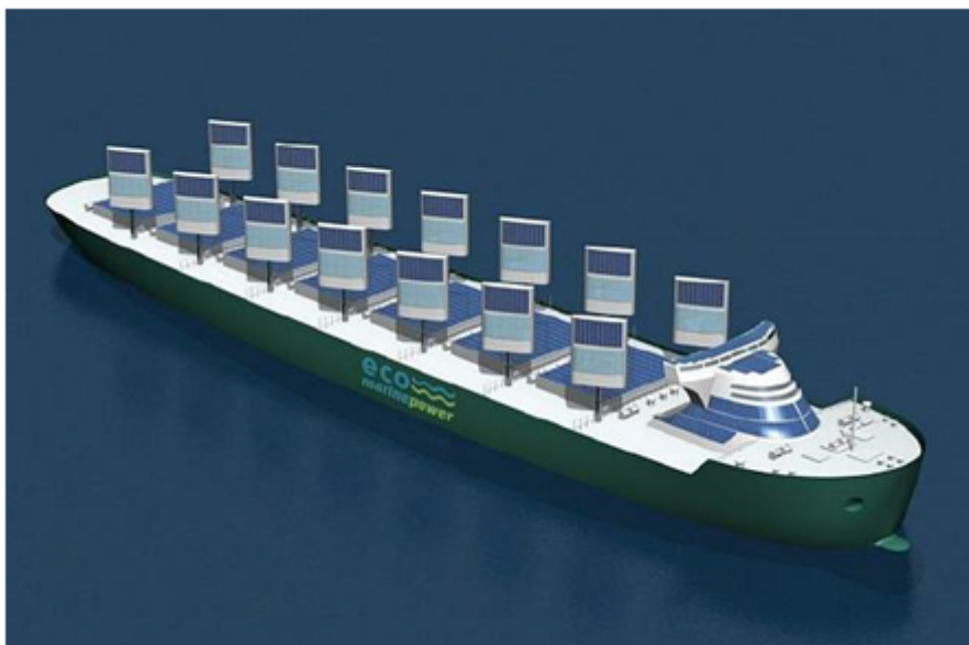
Рис.4. Технология жестких парусов «EnergySail»
