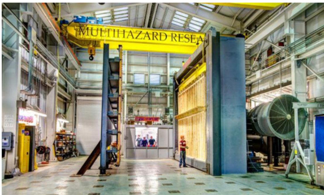
Рис.3. Многоосевой симулятор ветровой нагрузки с установленным испытательным образцом
