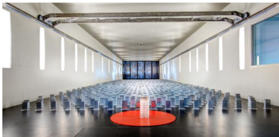
Рис.1. Аэродинамическая труба пограничного слоя с образцом для испытаний и массивом
