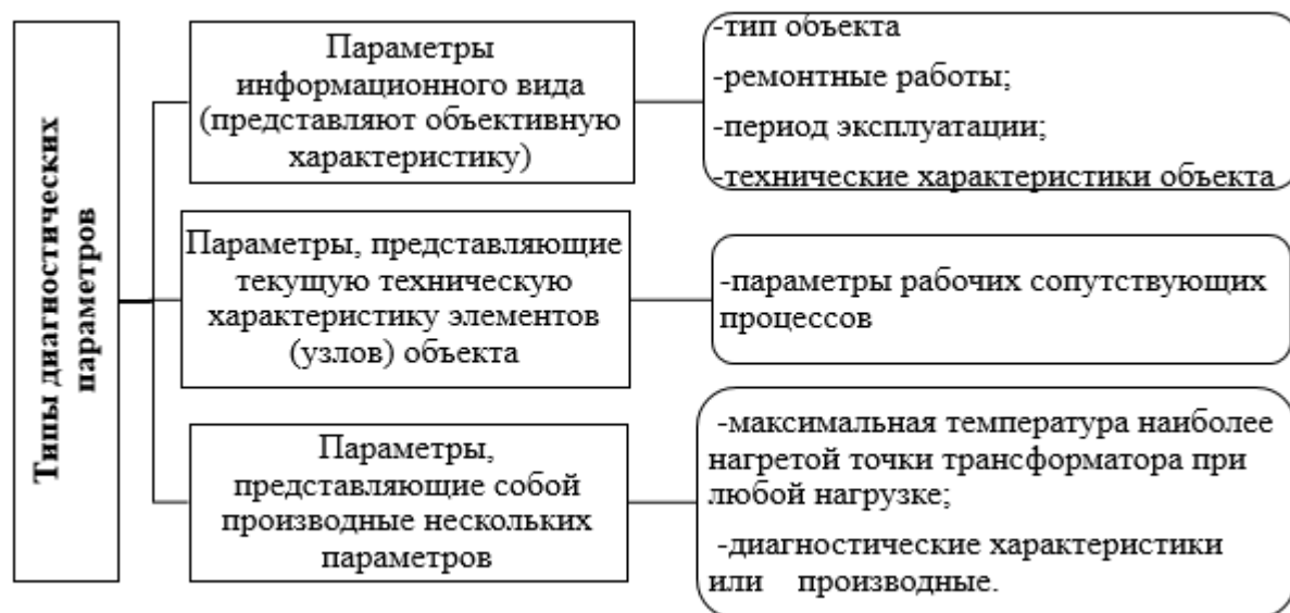
Рисунок 2. Типы диагностических параметров
