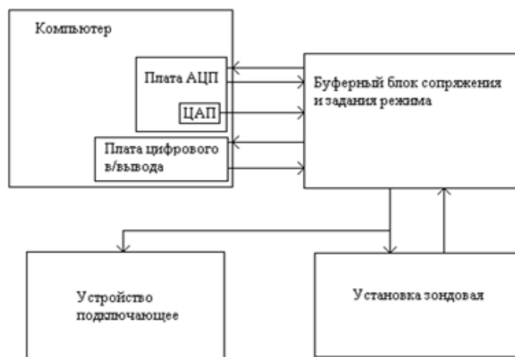
Рисунок 1 - Упрощенная блок-схема возможной структуры программно-аппаратного комплекса
